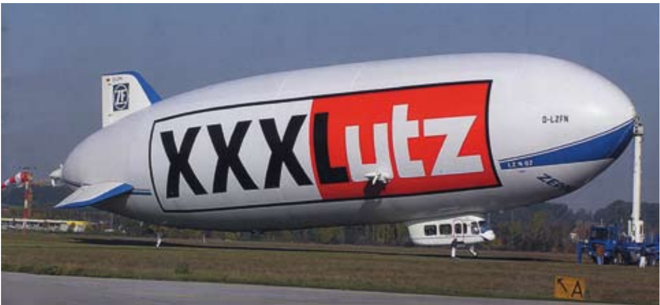
Länge 75 Meter, Breite 19,5 Meter, Höhe 17,4 Meter und ein Hüllenvolumen von 8225 m 3 . Geschwindigkeit 125 mk/h
