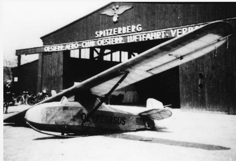
Die Brüder Hütter waren erfolgreiche Segelflugzeugkonstrukteure. Mit dem Kleinsegelflugzeug H 17 aus dem Jahre 1934 gelang ihnen ein großartiger Entwurf, der in zahlreichen Vereinen gebaut wurde. Im Bild die OE-Pegasus am Spitzerberg.
