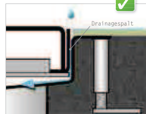
Auch bei Dehnungsrissen ist eine Entwässerung dank Drainagespalt über die Rinne gewährleistet.
