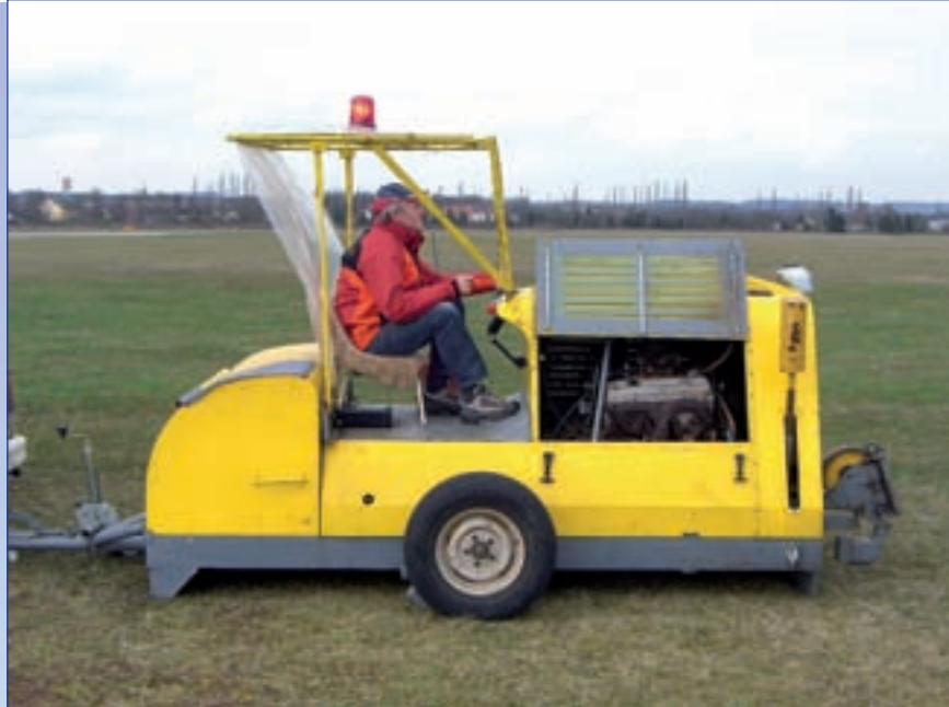
Umweltfreundliche Startart: mittels dieser Seilwinde wird ein rund 900 Meter langes Stahlseil eingezogen, an dem das Segelflugzeug auf eine Höhe von rund 300 Meter über dem Flugplatz geschleppt wird.
