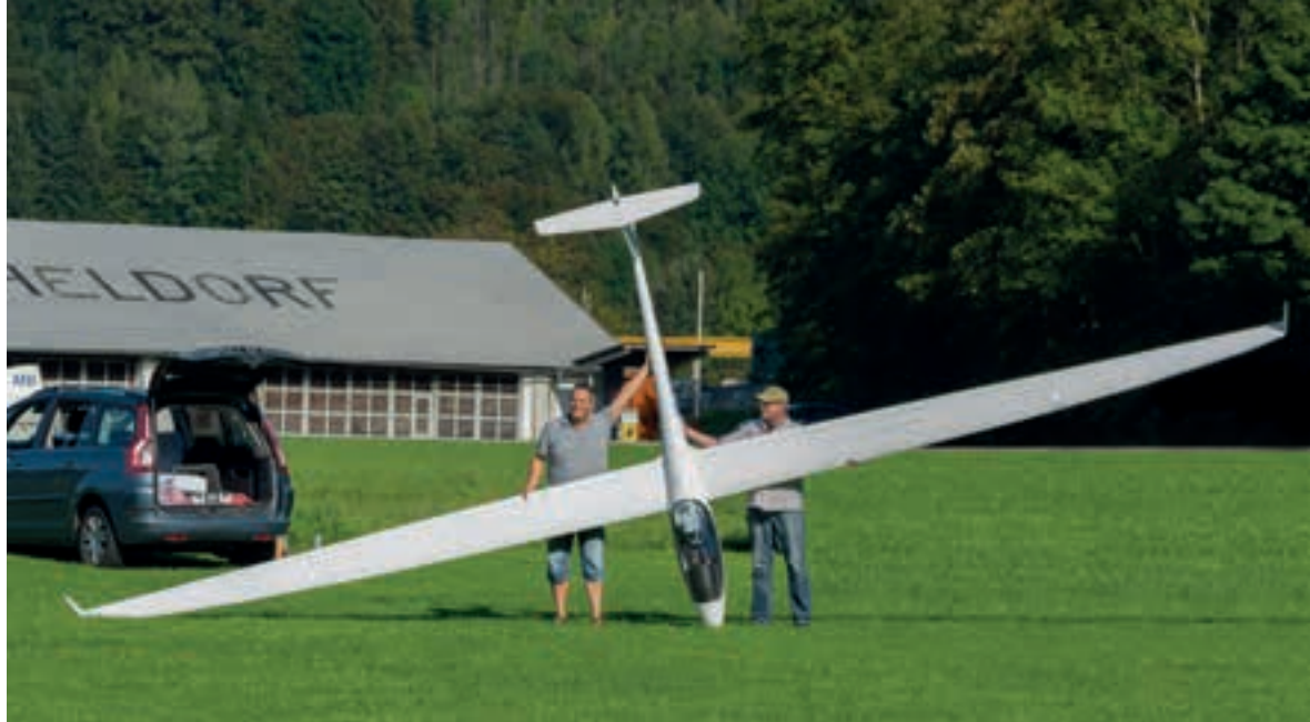
Gerhard Krenn und Richard Nikolic mit der ASG-29, Maßstab 1:2 Spannweite: 9 m, Rumpflänge 3,30 m
